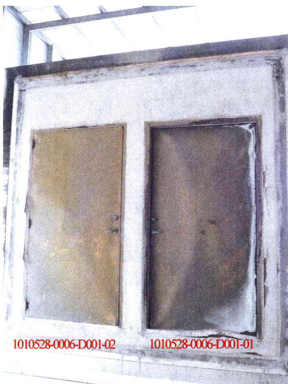
照片 4 加熱後試驗件加熱面
