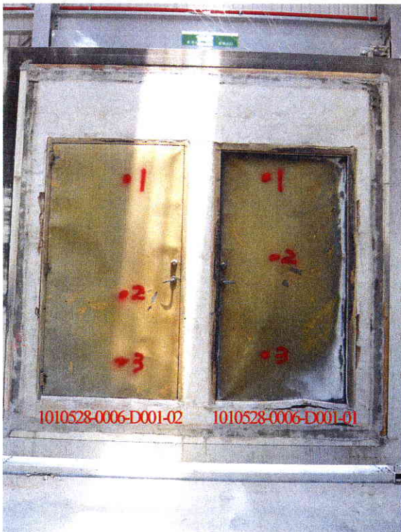
照片 6 衝擊後試驗件加熱面
