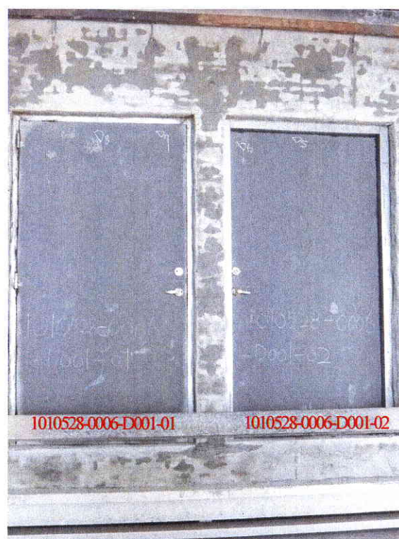
照片 5 加熱後試驗件非加熱面
