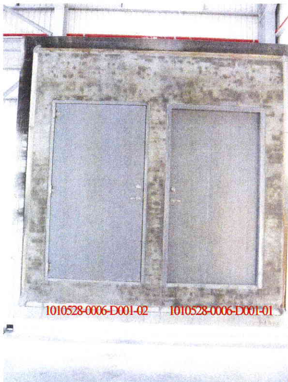
照片 2 加熱前試驗件加熱面
