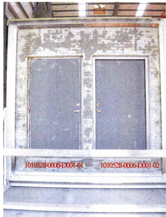
照片 7 衝擊後試驗件非加熱面
